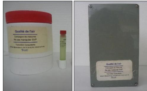
Réceptacle, tube passif pour NO<sub>2</sub> et micro-capteur laser
