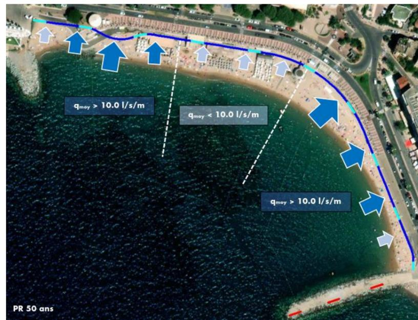
Répartition schématique des franchissements et de leur intensité en conditions de PR 1 an et de PR 50 ans
